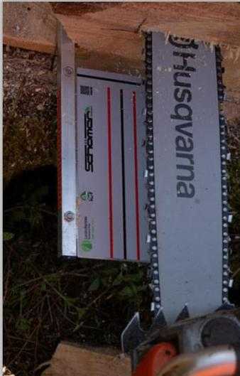
Ist die Schienenspitze sicher im Holz eingetaucht, d.h. die Schiene kann nicht mehr aus dem Stamm herauspringen (Kick-Back verhindern), Schiene/Motorblock nach vorne schwenken, bis die Schiene am senkrechten Strich der angezeichneten Bruchleistenstärke und parallel zu einer am nächsten passenden Linie der Fällfahne ausgerichtet ist.
