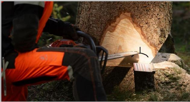
Mit der Schienenunterseite (**einlaufende Kette**), über der angezeichneten Bruchstufe und hinter dem senkrechten Strich der Bruchleistenstärke, einstechen.
